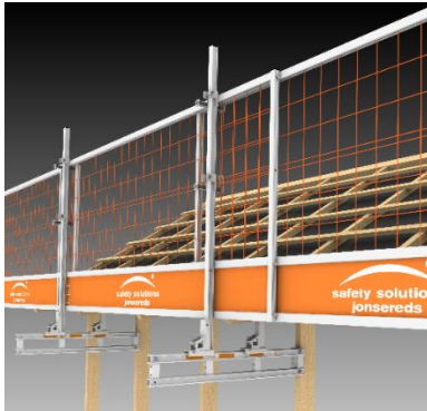
Figur 4. Temporärt skyddsräcke, klass B och C, vid takarbete vid taklutningar över 10 grader. Skyddsräckesklass A vid taklutningar under 10 grader och på ställningar vid fasad.
