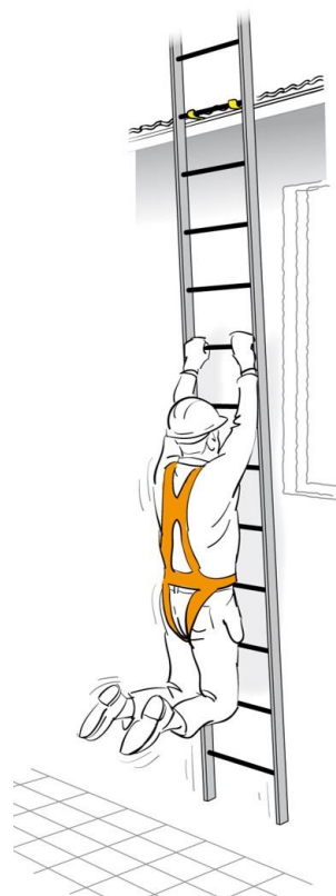
Figur 50. Test av glidskydd
